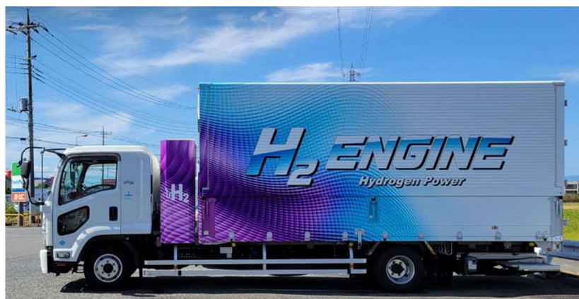
4 サイクル可変ノズル付ツインターボ混合水素エンジン、火花点火、高圧 70MPa 軽量水素タンク 4 本運転席裏搭載、白ナンバー取得環境省「令和 3～5 年度水素内燃機関活用による重量車等脱炭素化実証事業」
