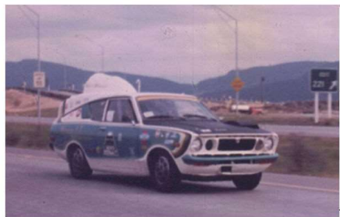
図 14 国内で初めて液体水素を断熱読嘔氣に貯蔵した容器を車に搭載し、そのタンク内で蒸発した極低温水素ガスを予混合火花点火水素エンジンに供給する予混合方式火花点火水素エンジンを搭載した武蔵 2 号車とその時に開発した水素燃料+エンジン系統図
