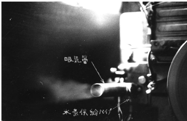
図 11 1970 年 12 月、日本で初めて単気筒吸気管連続噴射水素エンジンで起きたバック現象をとらえた写真：吸気管に火炎が逆火している（内燃研究室、野外バックヤードにて）
